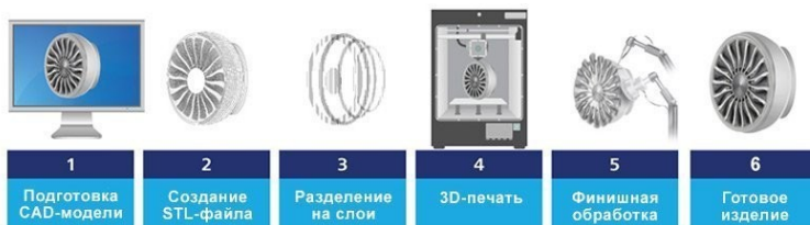
Рис. 1 Схема процесса аддитивного производства
